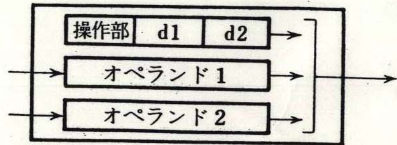
(b) 各命令セルの構造. d1, d2: デスティネーションセルを指定.
