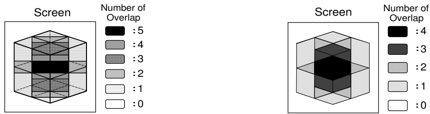
図 13: Bounding Box による重複度の分布 図 14: ピクセル単位による重複度の分布
